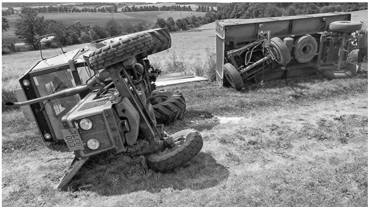
El tractor y el remolque volcados sugieren un fallo en el enganche o un equilibrio inadecuado de la carga durante el funcionamiento. Esto indica que el enganche no estaba bien asegurado o que el terreno y la pendiente no se evaluaron adecuadamente de antemano. Este tipo de vuelcos suponen un grave riesgo de lesiones o muerte para el operador y de daños al equipo.
