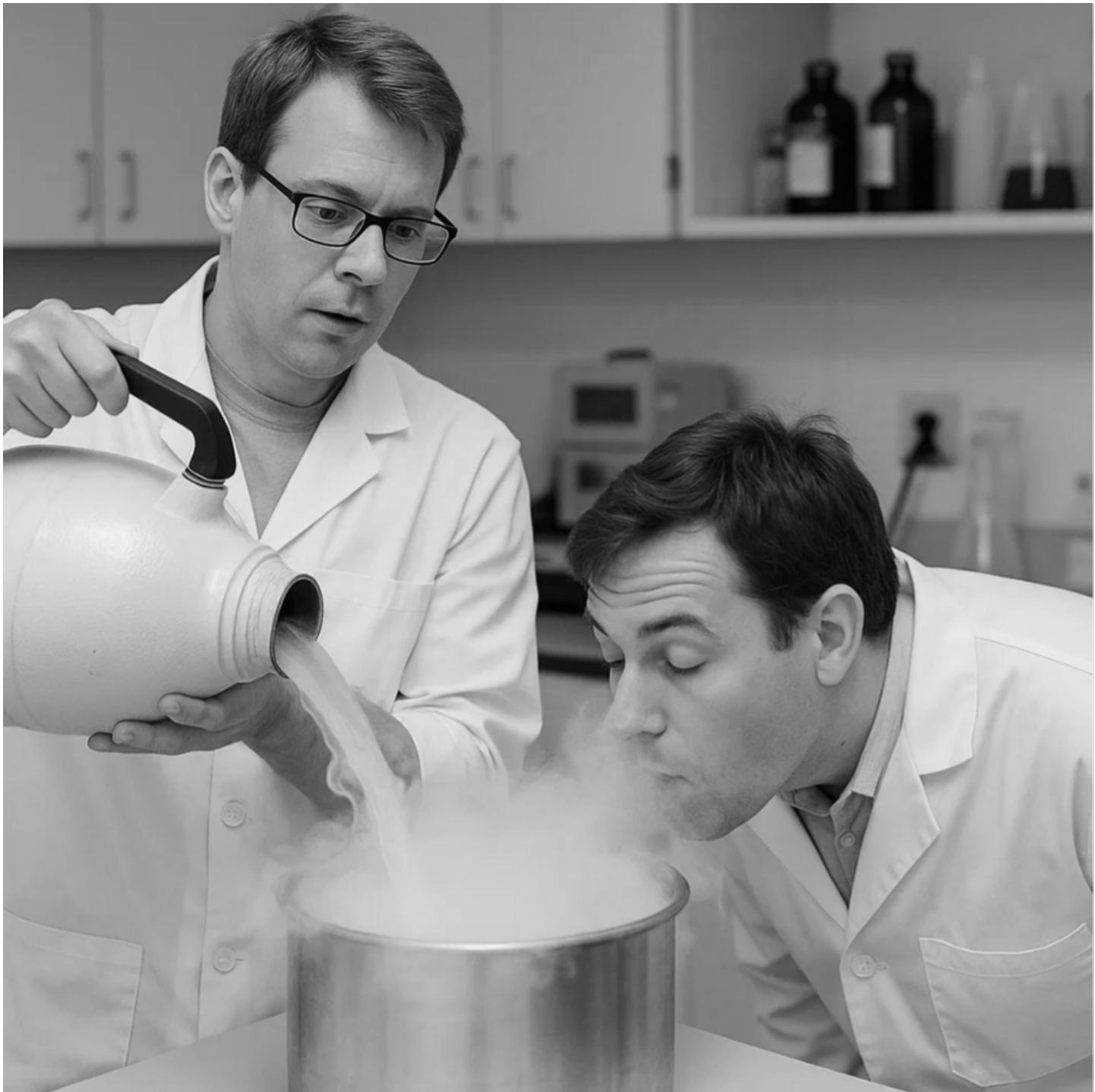
L'homme place son visage directement au-dessus de la vapeur d'azote liquide pendant qu'il est versé. Cela est extrêmement dangereux. La vapeur d'azote liquide peut déplacer l'oxygène, entraînant des vertiges ou une suffocation, et le froid extrême peut causer des brûlures cryogéniques au visage ou aux voies respiratoires.
