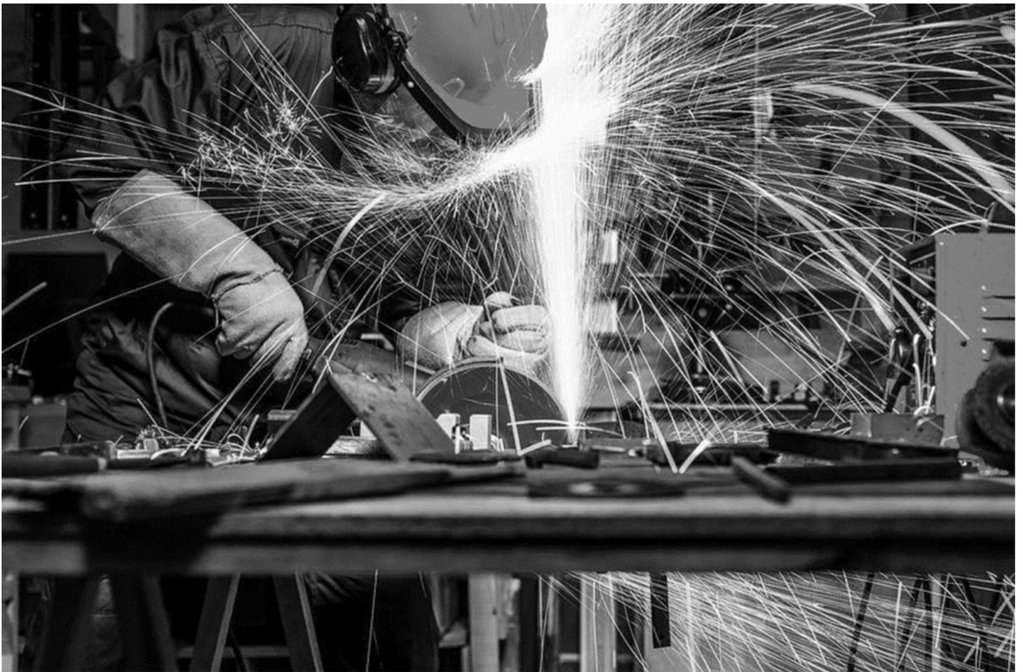
Mira la imagen de arriba y observe lo que está mal en esta foto, este trabajador está utilizando una amoladora angular de forma inadecuada, todas las chispas que salen le caen en la cara. Aunque lleve puesto su EPP, está utilizando esta herramienta de forma incorrecta y peligrosa.
